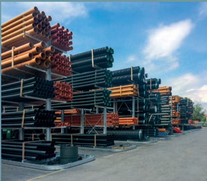
Opslag in buitenopstelling van kunststof buizen bij de groothandel. Warmverzinkte draagarmstellingen met geleidingsrails voor 4-wegstapelaar.
