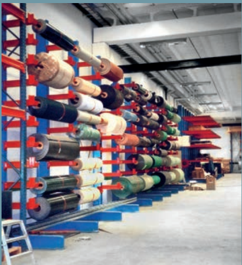
Draagarmstellingen met speciale op- en afname voor de opslag van rollen.
