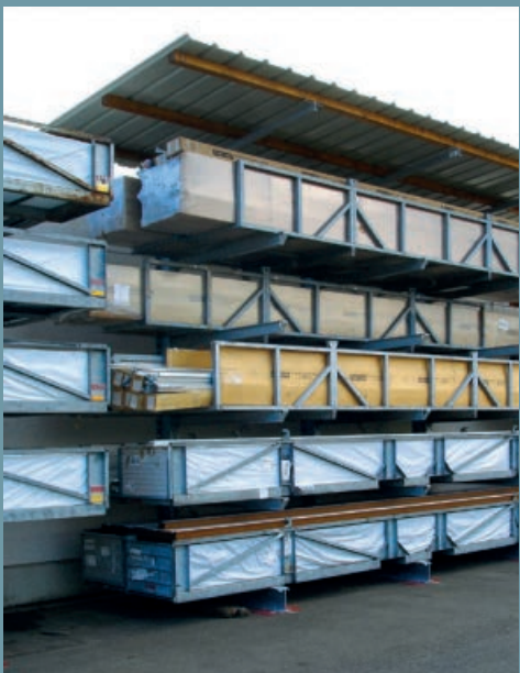
Kunststof profielen opgeslagen in cassettes en door het dak beschermd tegen de regen.
