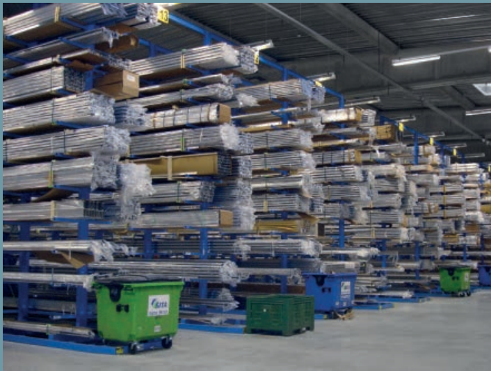
Smalganginstallatie met gangbruggen voor de opslag van aluminiumprofielen
