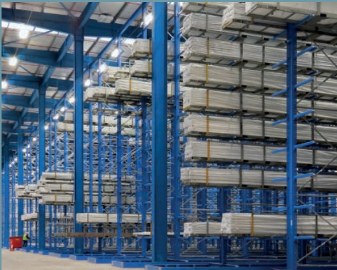
Draagarmstellingmagazijn van 13.500 mm hoog met 13 niveaus voor de opslag van alu- en kunststofprofielen in cassettes
