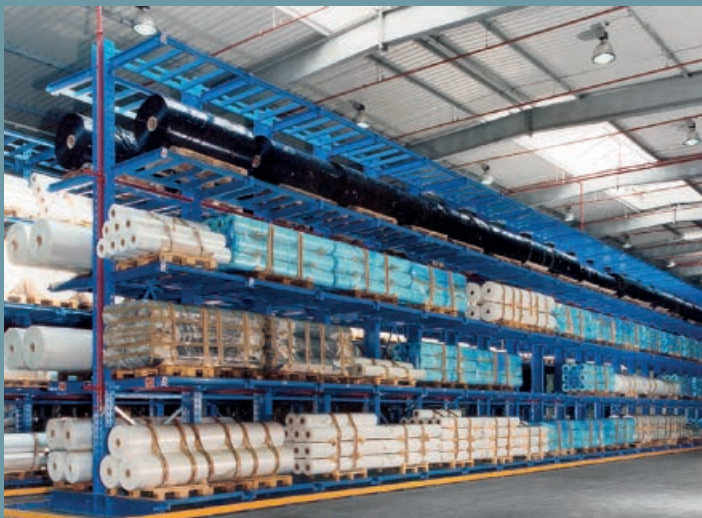
Draagarmstellingen met armbruggen voor de opslag van zware kunststoffolies.
