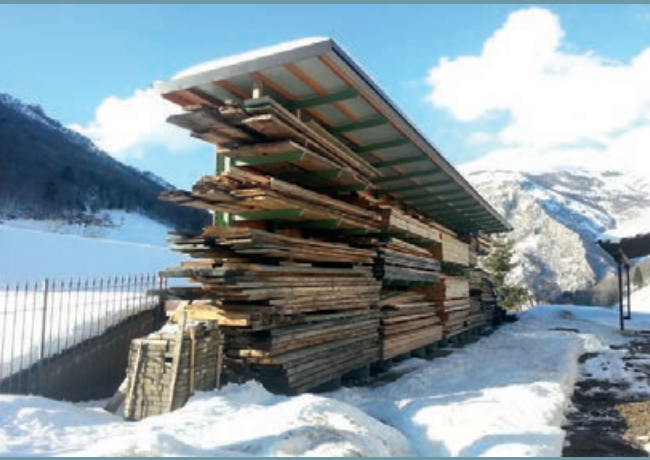
Draagarmrek met dak bij een timmermansbedrijf. Optimale opslag in open terrein
