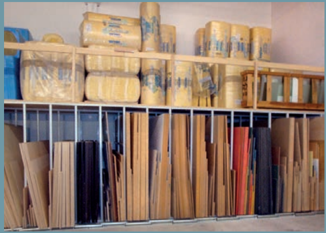
Rechtopstaande opslag van spaanplaat met gebruik van de bovenzijde als bijkomend opslagniveau
