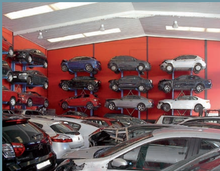
Overzichtelijke opslag van meerdere voertuigen boven elkaar. Gebruik van de voorhanden zijn halhoogte en wandoppervlak.
