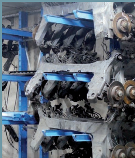
Opslagmogelijkheid van voertuigassen in draagarmstellingen. De afstanden tussen de steunen zijn variabel en de opslagniveaus zijn in de hoogte verstelbaar.
