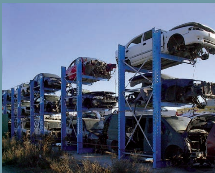
Compacte draagarmstellingen voor de opslag van sloopvoertuigen in openlucht. Geen verborgen roestvorming zoals bij buisprofielen door het gebruik van dikwandige staalprofielen.
