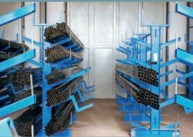
Schuine armstellingen voor opslag met kraan. Behandeling door middel van invoer- en orderverzamel insteekdoorn.
