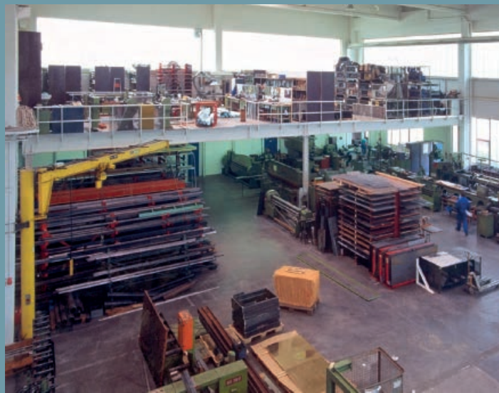
Verdubbeling van oppervlakte in de staalbewerking. Bovenaan en onderaan arbeidsplaatsen. Belasting van 1.000 kg/vierkante meter.
